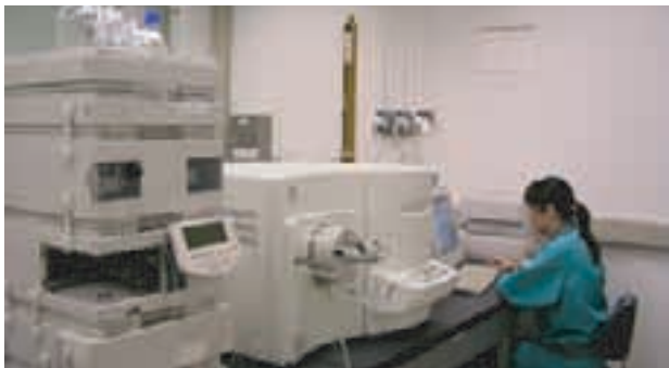
液体クロマトグラフ質量分析計による排水中有機物の分析
