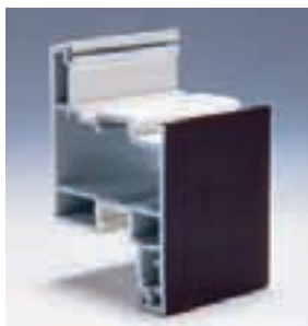
プラスチックサッシ部材のリサイクル。目に見える部分にはバージン素材(白色)、見えない部分にはリサイクル素材(灰色)を使用
