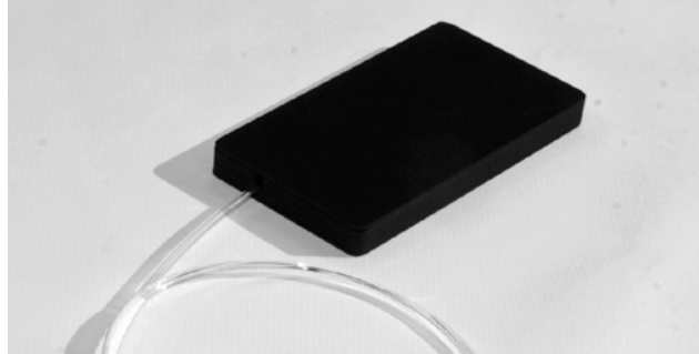
検出器への利用例（LiCAF シンチレータを組み込んだ携帯モジュール）
