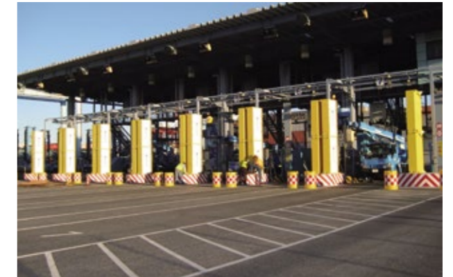
中性子線検出器を用いた核物質検出用のセキュリティゲート
