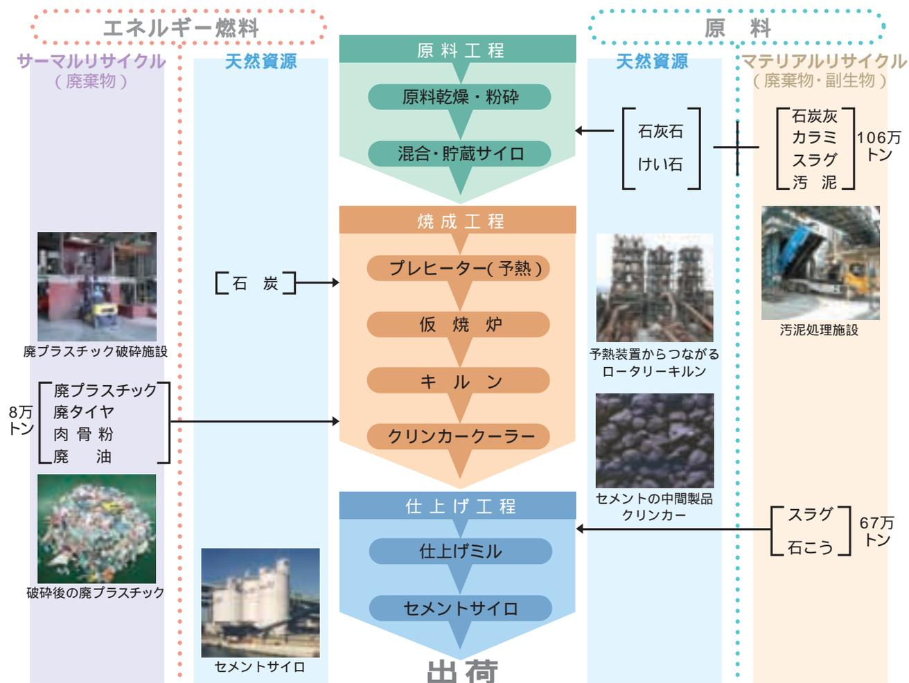
\*セメントキルン セメント工場では原料を焼成するのに用いる回転窯
