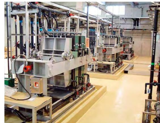
イオン交換膜による高性能透析装置「アシライザー」
