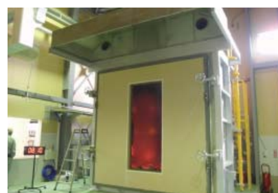
2009年10月29日に竣工した防耐火試験炉
