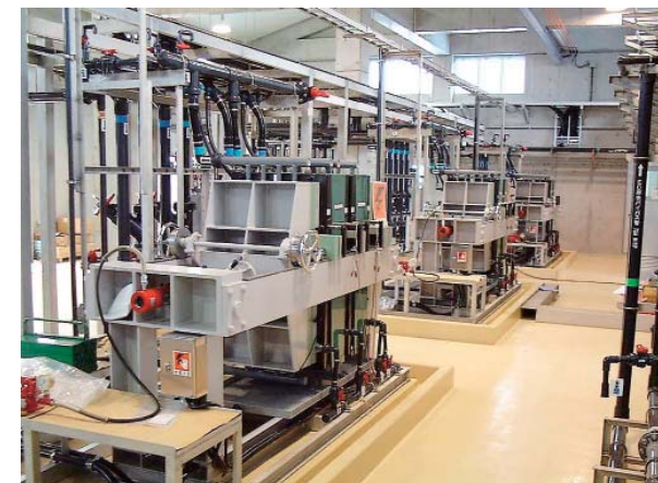
イオン交換膜による高性能透析装置「アシライザー」
