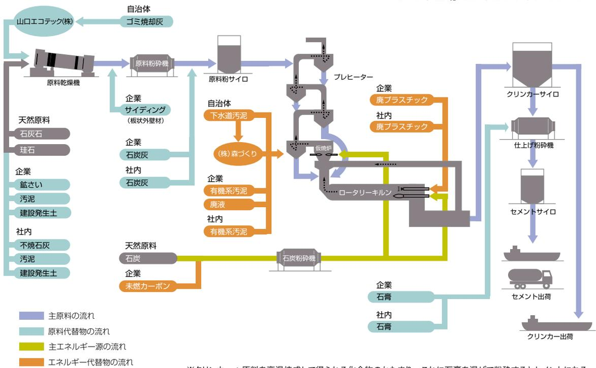
※クリンカー：原料を高温焼成して得られる化合物のかたまり。これに石膏を混ぜて粉砕するとセメントになる
