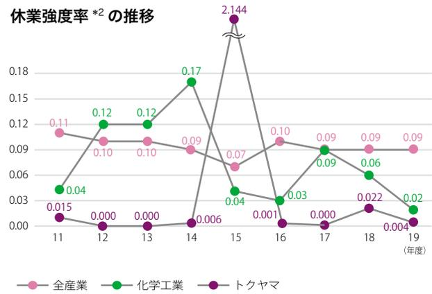
\*2 休業強度率：1,000のべ労働時間あたりの労働災害による労働損失日数で表示し、発生した労働災害の大きさを表す
