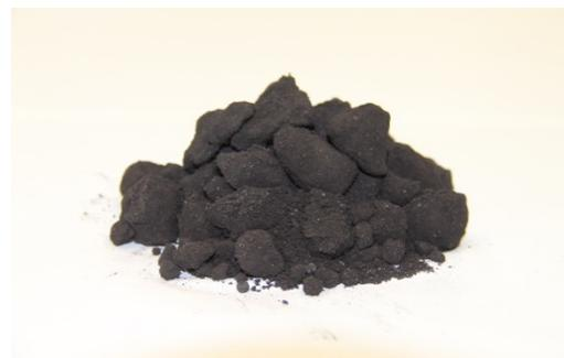
今回の試験施工では、当社発電所より発生するバイオマス燃焼灰に、当社セメント工場から発生した排ガス中の CO<sub>2</sub> を固定した後、これを原料として伊藤忠エネクスの関連会社を通じて CO<sub>2</sub> 固定型リサイクルビーズを製造、当社徳山製造所内の路盤工事に適用することで CCS を実現しました。試験施工完了までの一連の工程において使用した原材料とエネルギーに起因する CO<sub>2</sub> の発生量は、CO<sub>2</sub> 固定型リサイクルビーズ 1トン当たり 34.2kg でした。一方で、CO<sub>2</sub> 固定量は 61.0kg であることを確認し、本施工において CO<sub>2</sub> 固定型リサイクルビーズ 1トン当たり 26.8kg のカーボンネガティブを達成しました。
